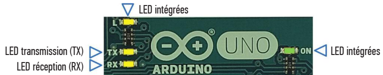
Figure 7 ▶ Trois LED importantes sur la carte Arduino
