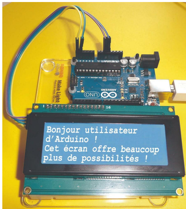
Figure 15-23 ► Afficheur LCD à 4 lignes (commande par bus I 2 C)
